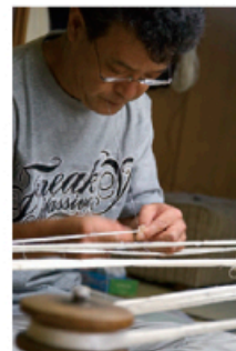
▲地機(じばた)を使い、よこ糸を3万回以上も打ち込んで織り上げる ◀手と口を使って純糸で固くしぼる「餅くくり」
